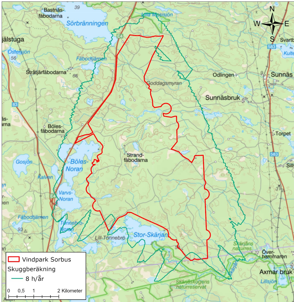
Figur 5-2. Preliminär beräkning av skuggutberedning. Den zon varinom den årliga skuggningen beräknas överstiga åtta timmar per år visas med grön linje. Beräkningen är baserad på en maximerad layout i föreslaget projektområde (röd polygon).
